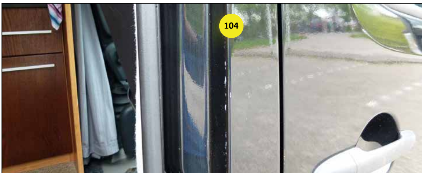
104 - Lichte beschadigingen spijl rechter zijdeur
