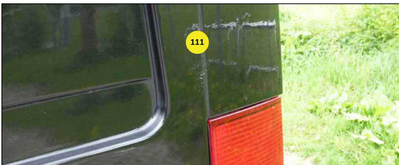
111 - Roest onder de lak boven linker achterlicht
