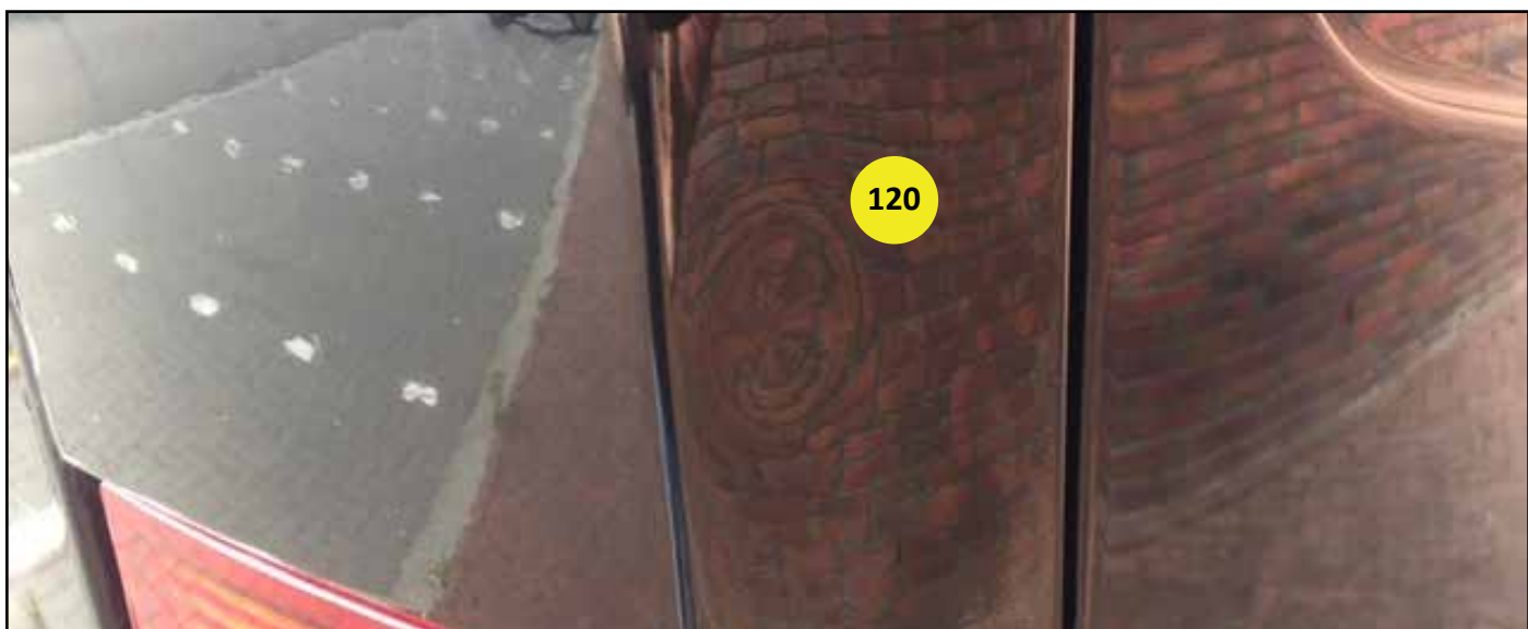
120 - Klein deukje / putje op post naast linker achterdeur boven het achterlicht
